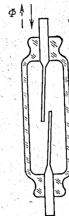
Рис. 5.16. Магнитоуправляемый контакт (геркон).
